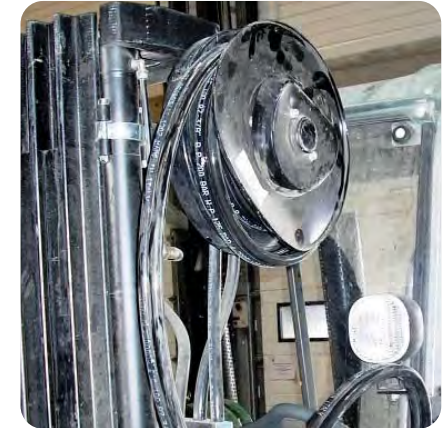
▶ Ødelagt slangetrommel eller tilhørende slanger
